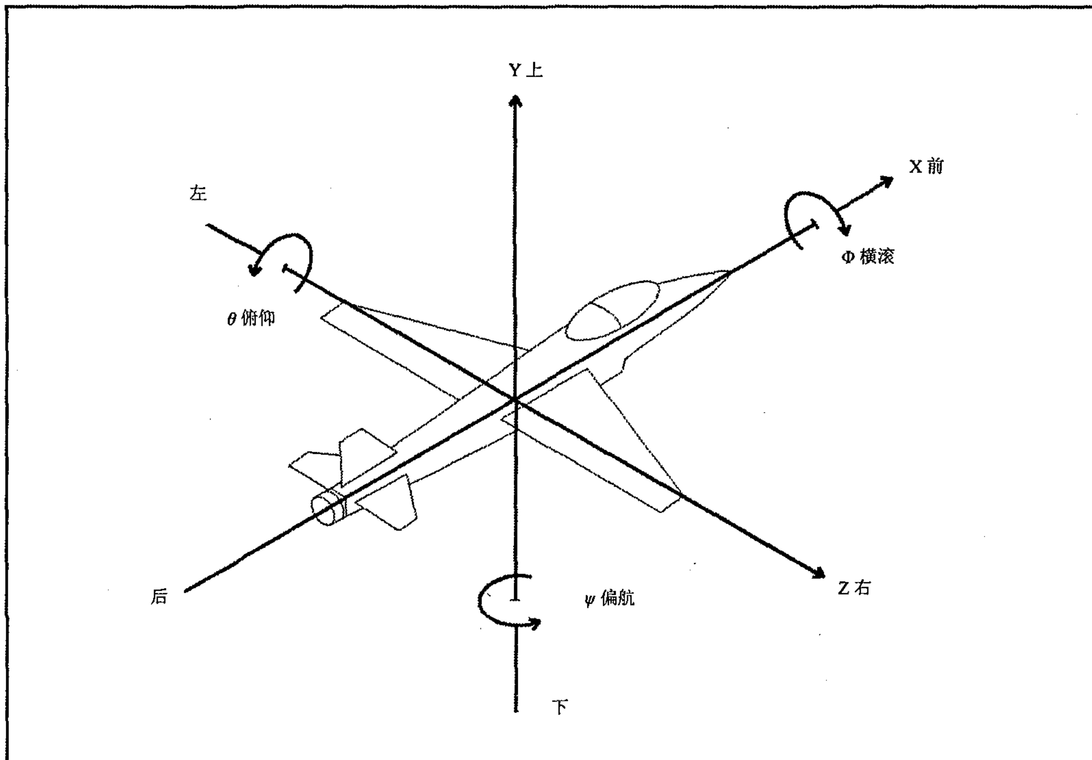
图 1 飞行器加速度方向
